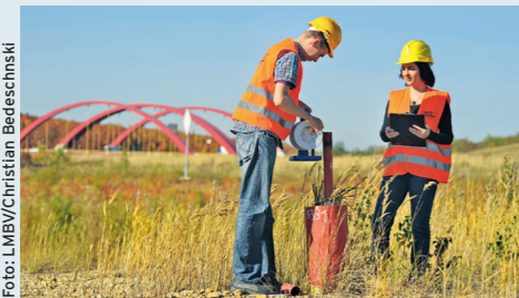
Mitarbeiter der LMBV bei der Pegelmessung des Grundwasserstandes.
